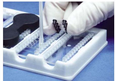
Abb. 2: Chip-zu-Chip-Fluidverbinder und Schlauchanschlüsse sorgen für fluidische Ankopplung der Chips untereinander und an die Laborumgebung.
